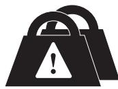
A lâmpada piscando indica que a plataforma está sobrecarregada e que as funções não funcionarão.
