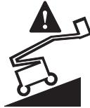
A lâmpada acesa indica que a máquina está desnivelada. O alarme de inclinação soa quando a lâmpada estiver acesa. Mova a máquina para uma superfície firme e nivelada.
